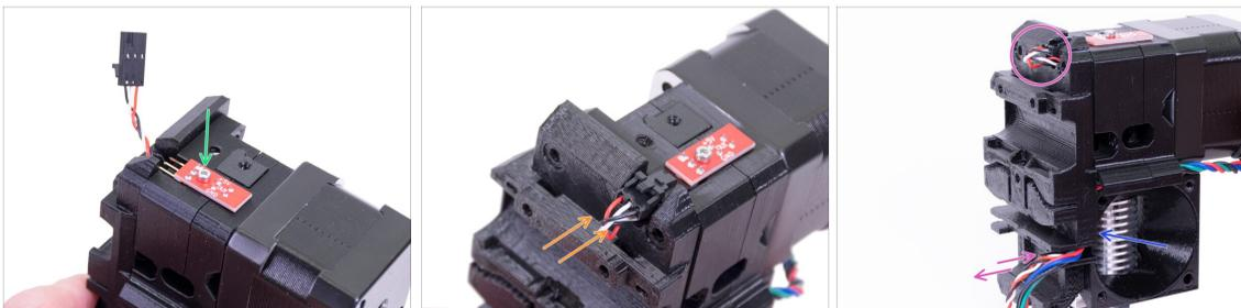
● Posiziona l'IR-sensor in cima al Extruder-body e fissalo con la vite M2x8. **Assicurati che la parte di plastica nera "a forma di U" sia rivolta verso il basso.**
