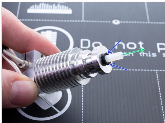
**⚠ DIESES SCHRITT IST OBLIGATORISCH!** Der MK3S+ verwendet im Vergleich zum MK3S einen kürzeren PTFE-Schlauch, den wir jetzt austauschen werden!
