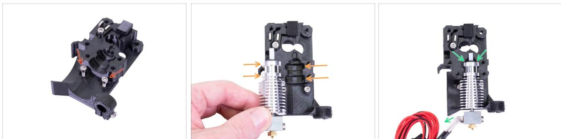
● Nehmen Sie zwei Schrauben M3x10 und stecken Sie sie in die Löcher. Dies macht die Montage jetzt etwas einfacher, aber beide Löcher sind nicht tief und die Schrauben können herausfallen. In diesem Fall können Sie ohne sie weitermachen und sie später wieder einsetzen (wir werden Sie darauf aufmerksam machen). *Beachten Sie auch, dass in einigen der nächsten Bilder die Schrauben fehlen könnten.*
