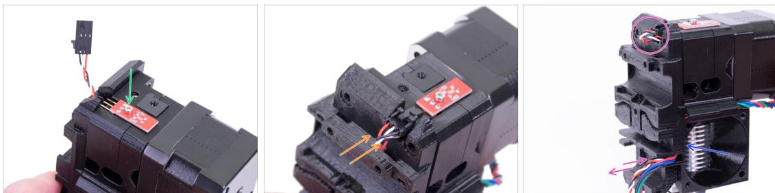
● Platzieren Sie den IR-Sensor auf der Oberseite des Extruderkörpers und sichern Sie ihn mit der M2x8 Schraube. **Vergewissern Sie sich, dass das schwarze "U-förmige" Teil aus Kunststoff nach unten zeigt.**
