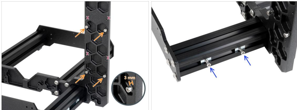
● Inserisci quattro viti M3x6 nella parte posteriore del telaio (lato con profili estrusi più corti), in modo da formare una sagoma rettangolare. Stringi completamente le viti nel telaio per pulire le filettature. Poi allenta le viti, **lasciando uno spazio di almeno 3 mm tra la testa della vite e il telaio.**
