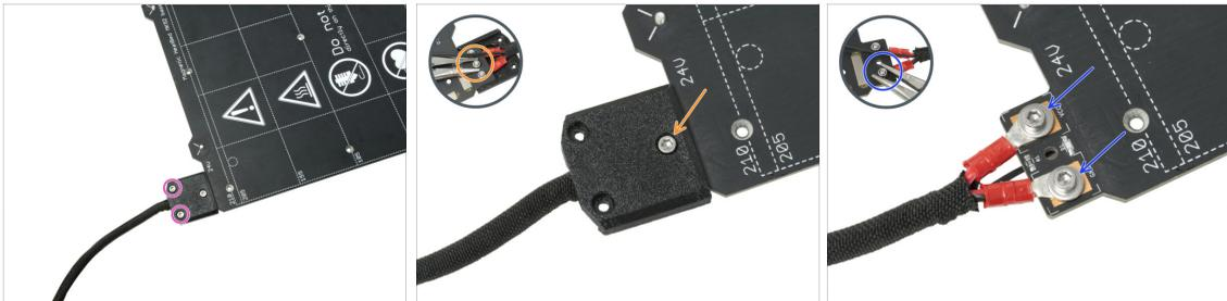
📌 Dans les étapes à venir, vous remplacerez l'ancienne thermistance du plateau chauffant (de votre ancien modèle d'imprimante) par une nouvelle version compatible avec les MK4S, MK3.9S, et MK3.5S.
