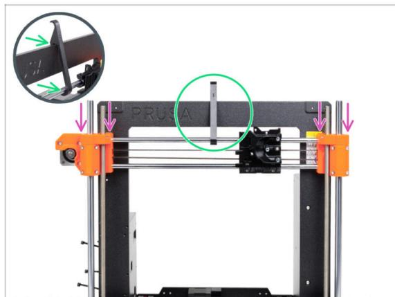
● Faites glisser délicatement l'assemblage de l'axe X sur les tiges lisses de l'axe Z.
