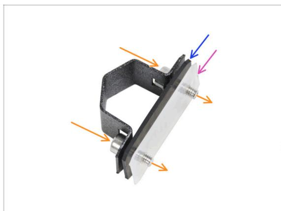
🟠 Poussez deux vis M3x8 à travers le clip de roulement.
