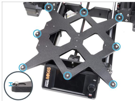
● Installez huit vis M3x6r dans les trous extérieurs du Y-carrriage. **Ne les serrez pas complètement.** Quelques tours suffisent pour l'instant.
