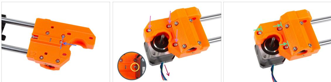
◆ Insérez la vis M3x10 dans le X-end-motor. Alignez-la avec le bord de la saillie en plastique. Ne serrez pas la vis, il n'y a pas de filetage à l'intérieur, insérez-la simplement librement.
