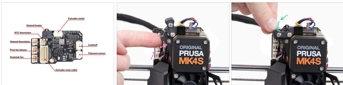
**⚠ Avant de couvrir l'électronique, vérifiez la connexion de tous les câbles. Cliquez sur l'aperçu haute résolution dans le coin supérieur gauche.**
