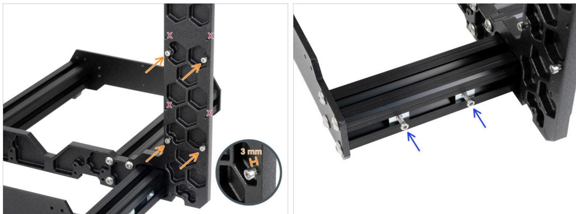
◆ Insérez quatre vis M3x6 à l'arrière du cadre (côté avec les extrusions les plus courtes), afin qu'elles ressemblent à un motif rectangulaire. Serrez complètement les vis dans le cadre pour nettoyer les filetages. Ensuite, desserrez les vis, **en laissant un espace d'au moins 3 mm entre la tête de vis et le cadre.**
