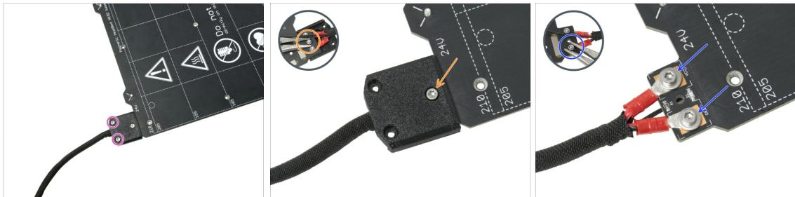
**💡** En los próximos pasos, sustituirá el termistor antiguo de la base calefactable (de tu modelo de impresora anterior) por una nueva versión compatible con MK4, MK3.9 y MK3.5.
