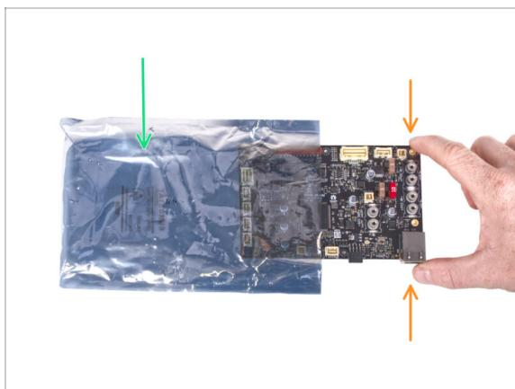
**⚠ ADVERTENCIA:** Asegúrate de proteger la electrónica contra descargas electrostáticas (ESD). ¡Desempaquetá siempre los componentes electrónicos justo antes de que los necesites!
