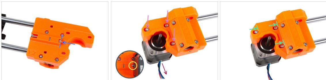
● Inserta el tornillo M3x10 en el X-end-motor. Alinéalo con el borde del saliente de plástico. No aprietes el tornillo, no hay rosca en el interior, simplemente insértelo libremente.
