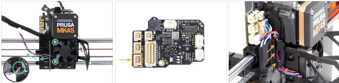
● Fija el ventilador del hotend al disipador con dos tornillos M3x18 en el lado izquierdo. **Aprieta el tornillo suavemente, pero con firmeza**, de lo contrario la carcasa de plástico podría agrietarse. El cable debe apuntar hacia la esquina inferior izquierda.
