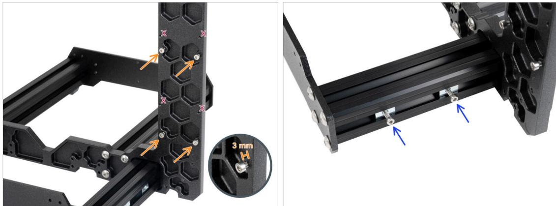
● Inserta cuatro tornillos M3x6 en la parte posterior del marco (lado con extrusiones más cortas), de modo que se asemejen a un patrón rectangular. Aprieta los tornillos a fondo en el marco para limpiar las roscas. A continuación, afloja los tornillos, dejando un espacio de al menos 3 mm entre la cabeza del tornillo y el marco.
