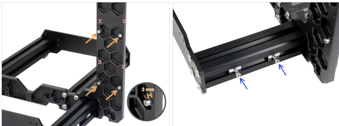
● Setzen Sie vier M3x6 Schrauben auf der Rückseite des Rahmens (Seite mit den kürzeren Profilen) ein, so dass sie ein rechteckiges Muster bilden. Ziehen Sie die Schrauben vollständig in den Rahmen ein, um die Gewinde zu reinigen. Lösen Sie dann die Schrauben, **lassen Sie dabei einen Spalt von mindestens 3 mm zwischen dem Schraubenkopf und dem Rahmen.**
