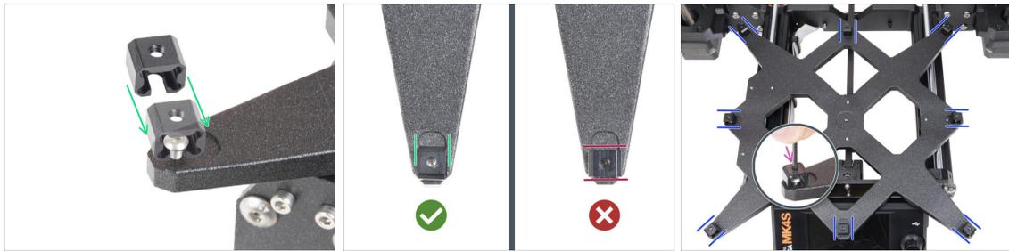
**⚠ Der Einbau der Ausgleichsverbindungen muss sorgfältig durchgeführt werden.** Er ist entscheidend für die korrekte Funktion des Druckers. Lesen Sie die Anweisungen sorgfältig durch:
