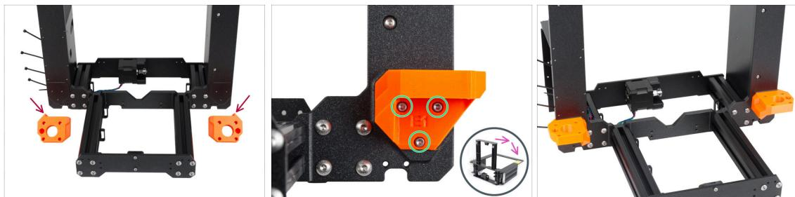
**⚠ ATTENZIONE:** le parti stampate non sono uguali! Ci sono parti destre e sinistre. Vedi la sporgenza (dente) su ogni parte. Per il lato destro del telaio, c'è una sporgenza sul lato destro della parte in plastica e viceversa.
