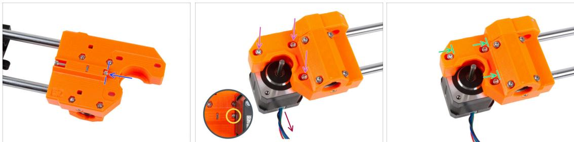
◆ Inserisci la vite M3x10 nel terminale X-end-motor. Allineala con il bordo della sporgenza di plastica. Non provare a stringere la vite, in quanto non c'è filettatura all'interno. Inseriscila e basta.
