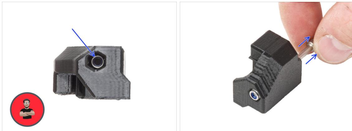
◆ Insérez l'écrou M3nN à fond dans le Y-belt-holder.
