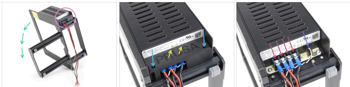
**⚠ Dieser Schritt ist nur für das schwarze Netzteil! Demontieren Sie unter keinen Umständen das silberne Netzteil!!**
