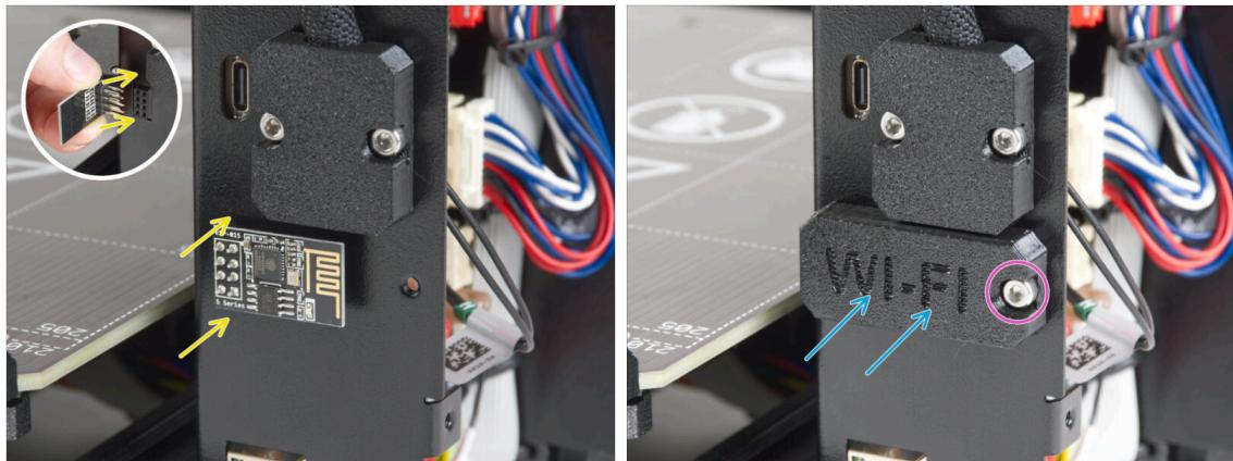
**⚠ Seien Sie sehr vorsichtig bei der Handhabung und dem Anschluss des ESP-Moduls, um ein Verbiegen und Beschädigen der Stifte zu vermeiden.**
