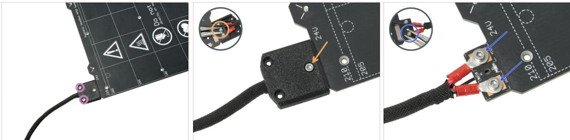
**💡** In den nächsten Schritten werden Sie den alten Heizbett-Thermistor (von Ihrem vorherigen Druckermodell) durch eine neue Version ersetzen, die mit dem MK4, MK3.9 und MK3.5 kompatibel ist.
