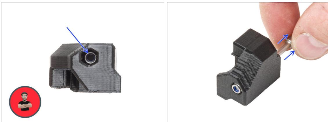
◆ Stecken Sie die M3nN-Mutter bis zum Anschlag in den Y-belt-holder.
