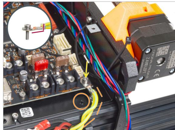
◆ Collega il connettore del cavo PE al foro inferiore destro della scatola xBuddy. Fissa il cavo con la rondella M3w e la vite M3x6. Stringi saldamente la vite.
