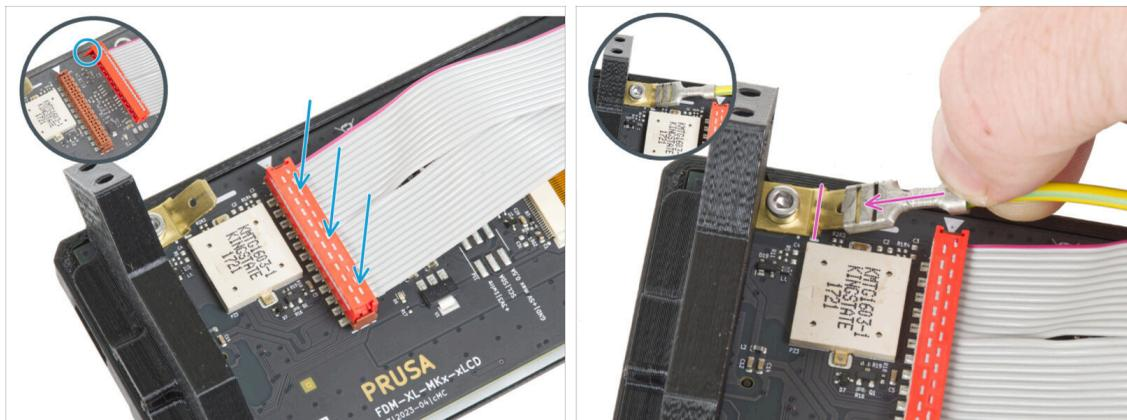
● Collega il cavo xLCD alla scheda xLCD. Nota la chiusura di sicurezza sul connettore del cavo xLCD. Deve essere inserito nel lato dello slot xLCD contrassegnato dal simbolo a triangolo sulla scheda.
