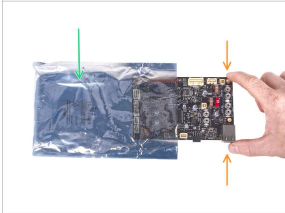
**⚠ ATTENZIONE:** Accertati di **proteggere l'elettronica dalle scariche elettrostatiche (ESD)**. Spacchetta sempre l'elettronica solo non appena ti serve!
