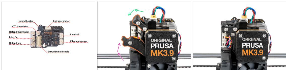
**⚠️ Bevor Sie die Elektronik abdecken, überprüfen Sie den Anschluss aller Kabel. Klicken Sie auf die hochauflösende Vorschau in der oberen linken Ecke.**
