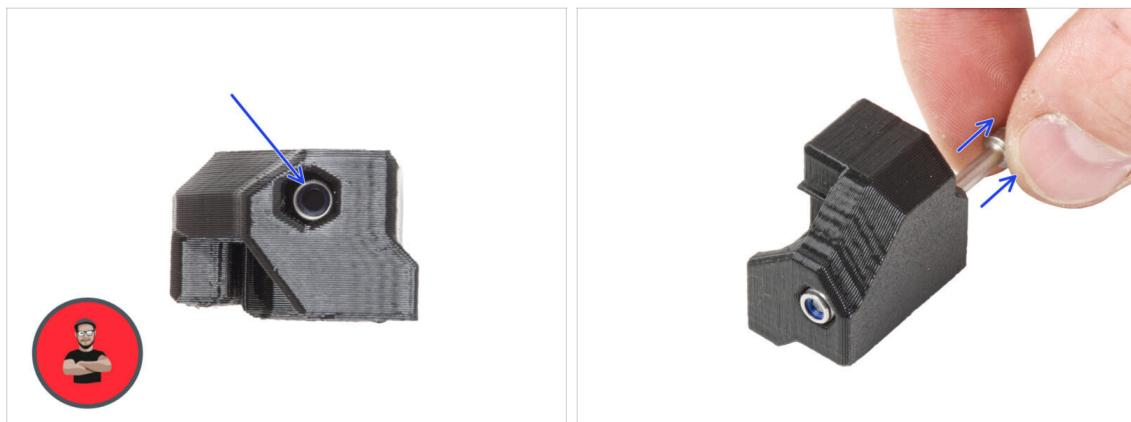
◆ Stecken Sie die M3nN-Mutter bis zum Anschlag in den Y-Riemenhalter.
