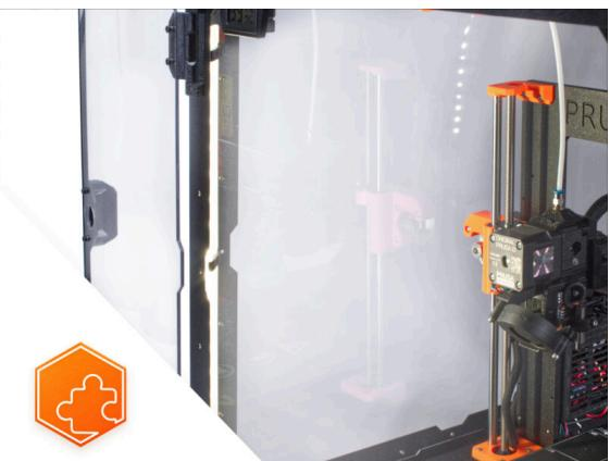
◆ Vérifiez si cela fonctionne correctement. Appuyez sur le bouton LIGHT sur le Basic Board Panel et vérifiez si l'éclairage LED à l'intérieur s'est allumé.
