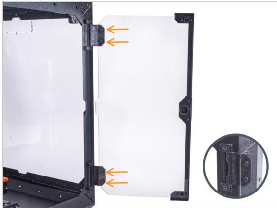
🟡 Öffnen Sie die rechte Türklappe und lösen Sie alle vier Schrauben an den Scharnieren.
