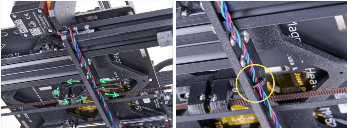
⚠ In den nächsten Schritten **ziehen Sie alle Kabelbinder sehr vorsichtig fest**, da die Kabel sonst angeknickt oder durchtrennt werden könnten.
