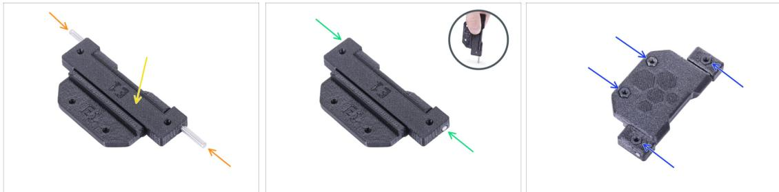
● Setzen Sie das Gehäusescharnier in das Türscharnier ein. Achten Sie auf die richtige Ausrichtung der beiden Teile.
