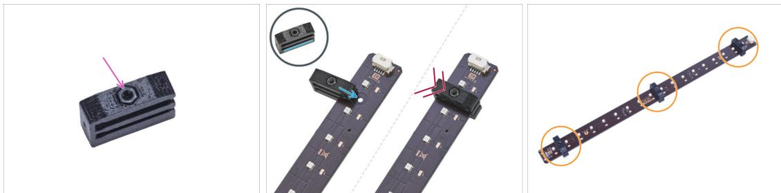
● Setzen Sie die M3n-Mutter in jede LED-Platinen-Halterung ein.
