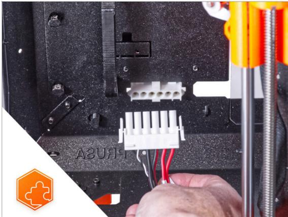
● Diese Anleitung führt Sie durch die Installation des **Schnellverschluss-Netzteil-Kabels** am **Original Prusa Enclosure**.
