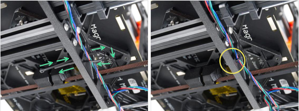
⚠ V následujících krocích **prosím utahujte stahovací pásky opatrně**, neboť můžete skřípnout/zlomit kabely.
