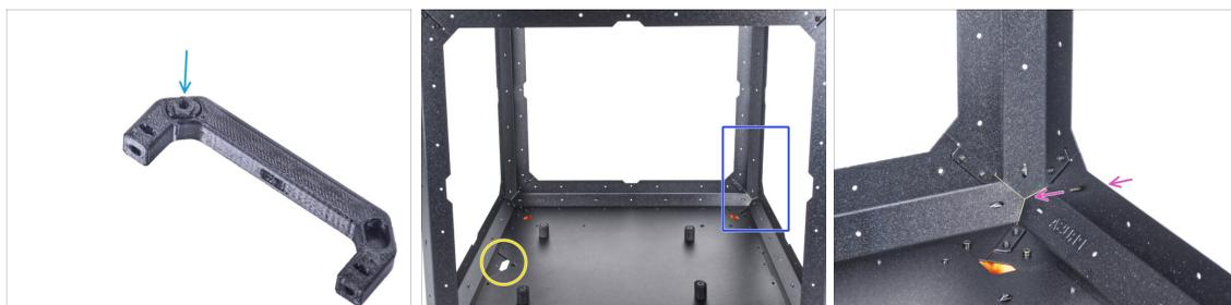
ⓘ V následujících krocích použijeme úchyt zdroje napájení (PSU-handle) jako nástroj k upevnění zámků zdroje (PSU-locks).
