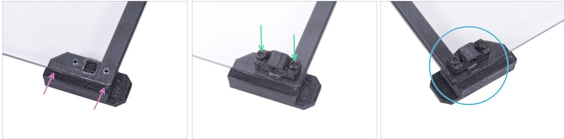
**⚠ Šrouby v panelu dveří příliš neutahujte! Panel by mohl prasknout.**
