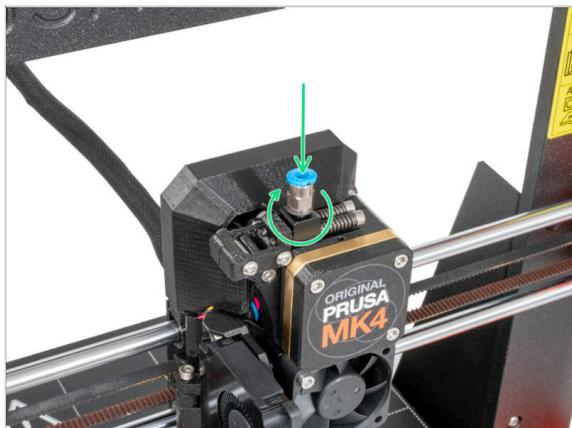
◆ Vložte a našroubujte fitink QSM-M5 přímo do závitového otvoru pro filament v extrudéru.
