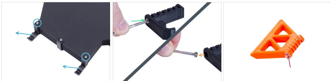
● Povolte dva šroubky zajišťující díl s-buffer-hook-uni a odstraňte tištěný díl ze zásobníku.
