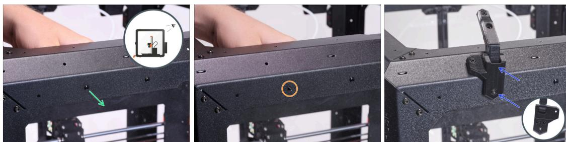
⚠ Se hai installato il sistema di filtrazione avanzato, utilizza la staffa con cerniera [hinge-bracket-Rt](https://printables.com) disponibile su [printables.com](https://printables.com)
