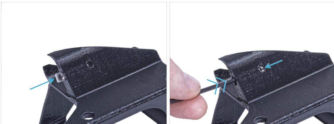
● Inserisci il dado M3nS nella staffa dell'alimentatore esterno (External-PSU-bracket-DELTA). Utilizzando la chiave a brugola, spingi il dado fino in fondo nella parte stampata e allinealo con il foro della componente.
