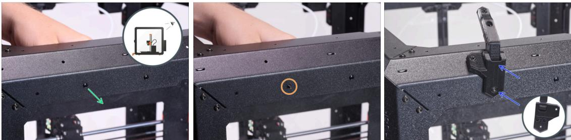
**⚠ Si vous avez installé le module complémentaire du système de filtration avancé, utilisez le hinge-bracket-Rt disponible sur [printables.com](http://printables.com)**
