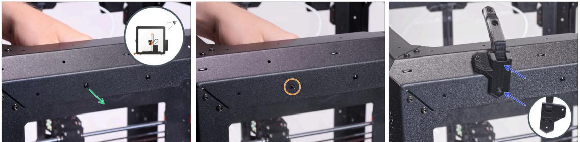
⚠ Si ha instalado el complemento del Sistema de filtración avanzado, utiliza la hinge-bracket-Rt disponible en [printables.com](http://printables.com)
