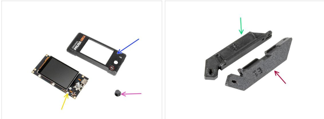
**i** Für das **spritzgegossene xLCD auf dem MK4S** werden neue Halterungen benötigt. **Verwenden Sie nicht alte und neue Teile zusammen!** Die neuen xLCD-Halterungen können von [Printables.com](https://printables.com) heruntergeladen werden.
