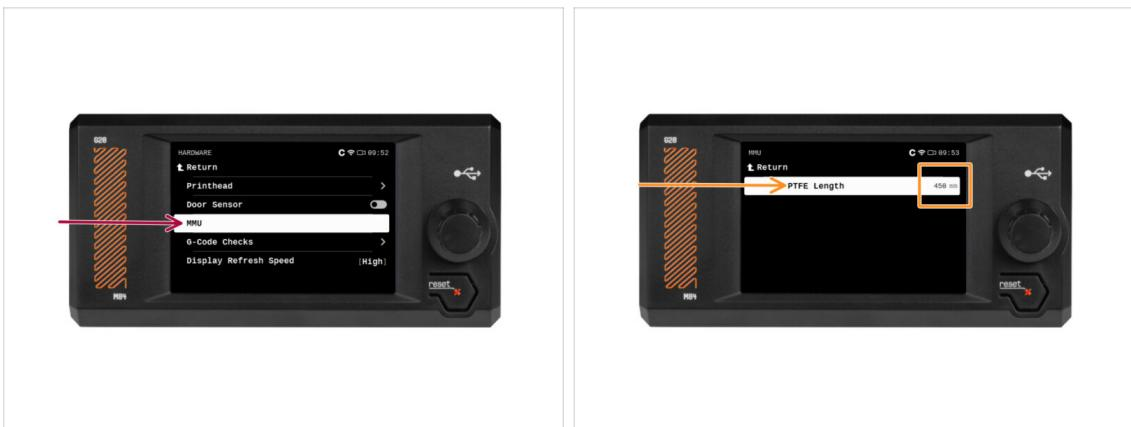
**⚠** È necessario impostare nel firmware la lunghezza del tubo PTFE MMU-to-Extruder.
