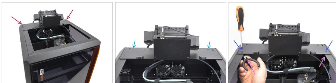
● Placez l'assemblage du MMU avec le support métallique sur l'imprimante. Assurez-vous qu'il se trouve à l'arrière du renforcement supérieur, avec le MMU face à l'avant de l'imprimante.
