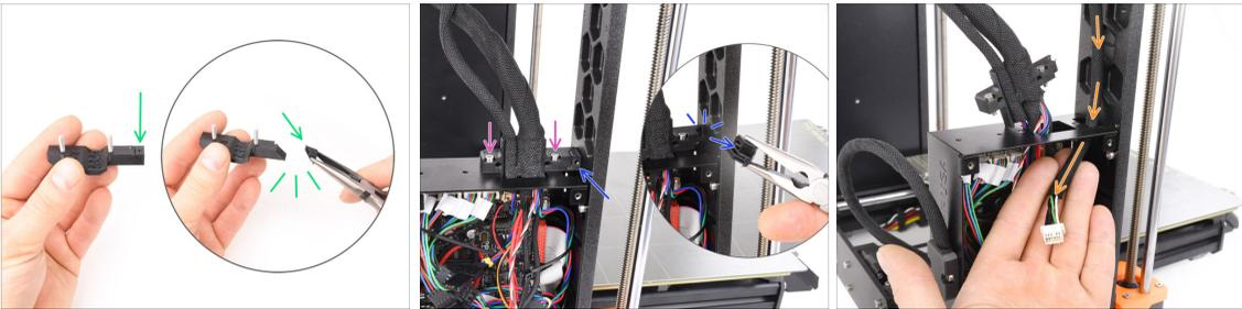
**•** Prendre le composant en plastique **Ext-cable-holder-a**. Il y a une petite partie qui doit être cassée afin de faire de la place pour le câble MMU. Retirez la pièce à l'aide d'une pince à bec effilé.
