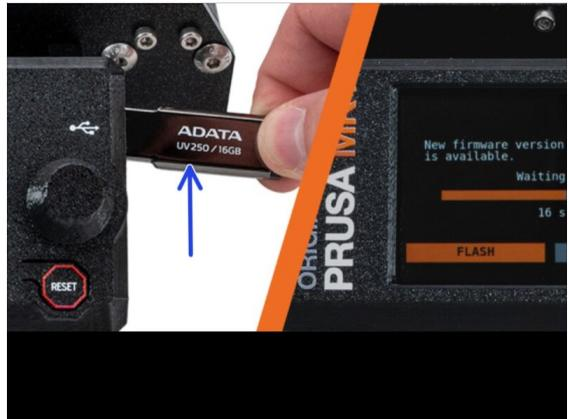
**⚠ IMPORTANT !!!** Avant d'aller plus loin ; Il existe deux fichiers de firmware. L'un est destiné à l'imprimante. L'autre est destiné à l'unité MMU3. Les deux doivent être flashés sur l'appareil respectif.
