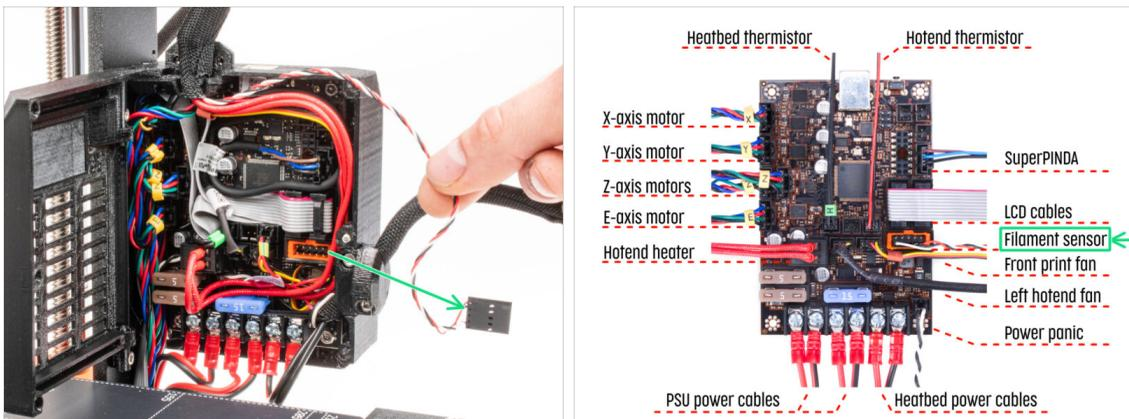
🟢 Débranchez soigneusement le **câble du capteur de filament IR** et assurez-vous qu'il est libre à l'intérieur du boîtier électronique.
