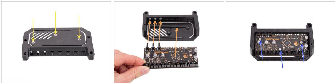
◆ Insérez les trois écrous M3n dans les ouvertures marquées en haut du capot de l'électronique. Poussez-les à fond.
