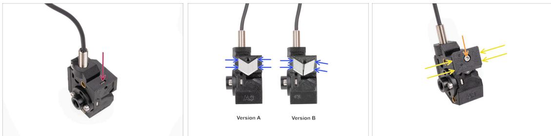
● Insérez l'écrou M3nS dans l'ouverture marquée en haut du sélecteur. Poussez-le à fond.
