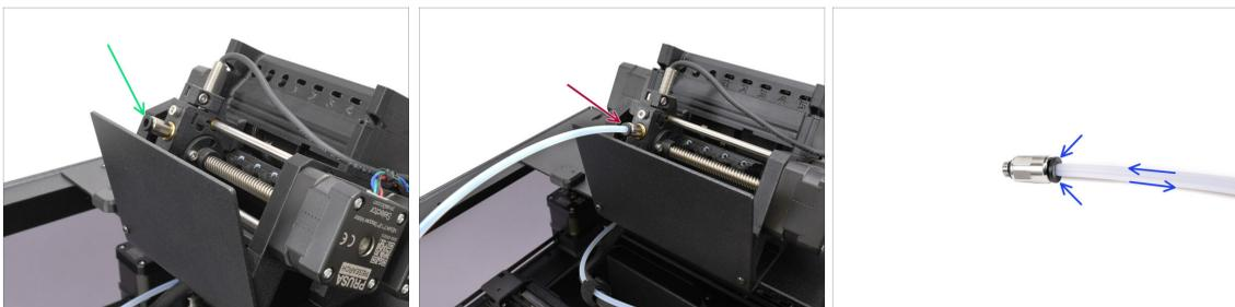
● Fixez le raccord M5-4 sur le Sélecteur et serrez-le à l'aide de l'Uniwrench.
