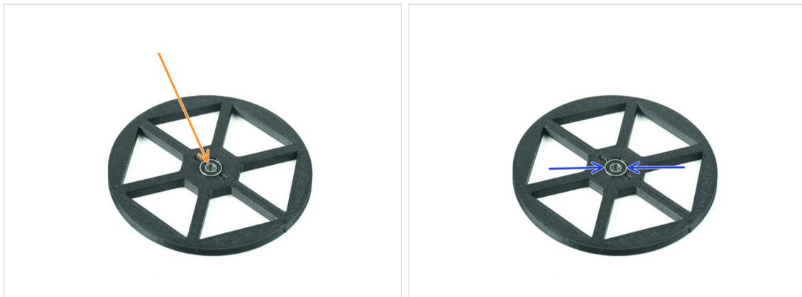
● Insérez le roulement dans l'ouverture centrale de la roue.
