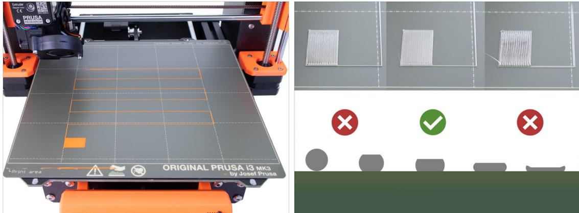
**⚠ IMPORTANT :** Cette étape est nécessaire pour la **MK3S+** si vous avez précédemment travaillé sur la tête de l'extrudeur. Si vous avez uniquement remplacé l'ancienne cheminée par la nouvelle, vous pouvez passer à l'étape suivante et utiliser l'**Ajustement en direct en Z** fonctionner comme d'habitude pour affiner la première couche.
