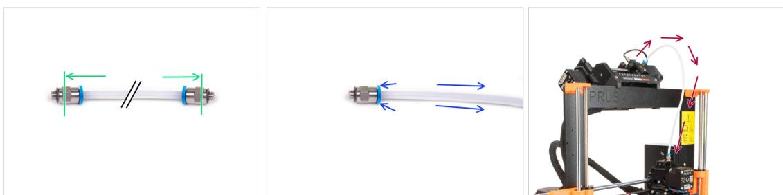
● Fixez les raccords M5-4 sur les deux côtés du nouveau tube PTFE (4x2,5x360 mm)
