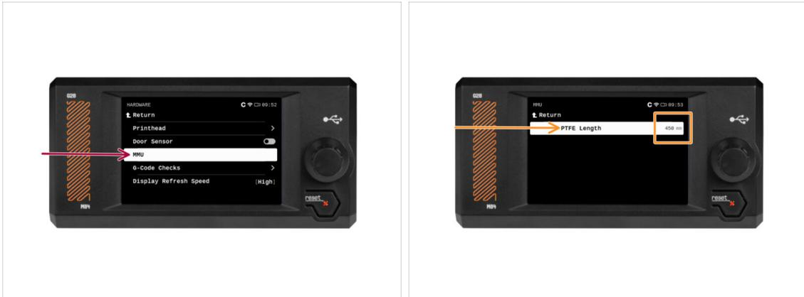
⚠ La longueur du tube PTFE MMU-vers-Extrudeur doit être définie dans le firmware.
