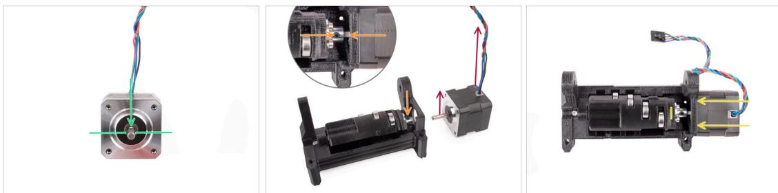
❗ Antes de añadir el motor al conjunto, debemos alinear el eje del motor y el acoplamiento del tensor.
