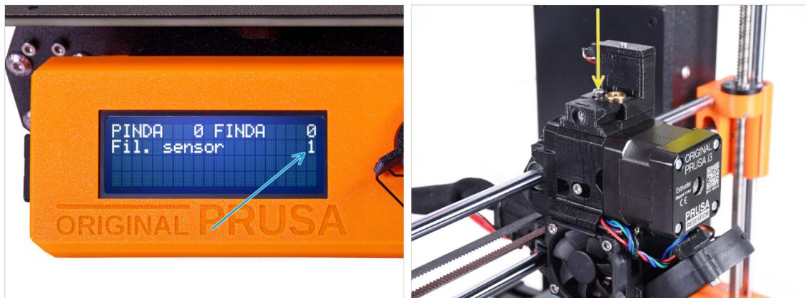
**⚠ ¡Calibrar el sensor de filamento IR es supercrucial para que la unidad MMU3 funcione correctamente!**
