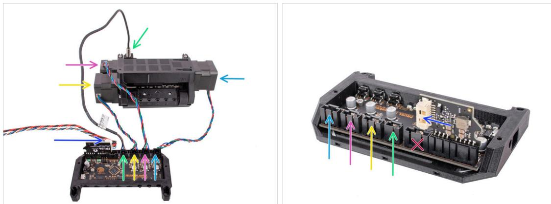
● Prepara la unidad y el conjunto de la placa electrónica como se ve en la imagen. Sigue los cables para conectarlos en el orden correcto.
