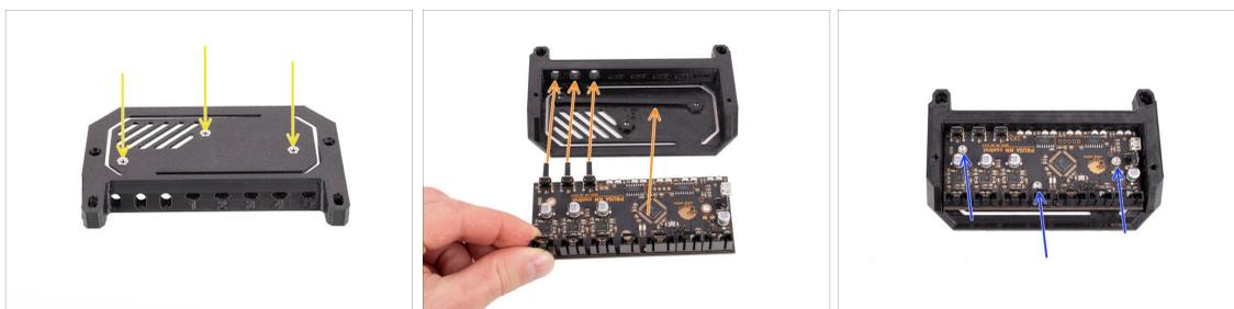
⬢ Inserta las tres tuercas M3n en las aberturas marcadas en la parte superior de la cubierta de la electrónica. Empújalas todas hasta el fondo.
