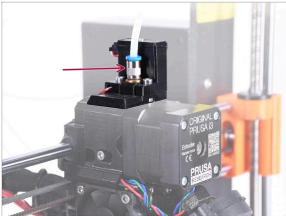
● Tu unidad MMU ya está lista. En los siguientes pasos, trabajaremos en el extrusor. En concreto, el sensor de filamento dentro de la "chimenea".
