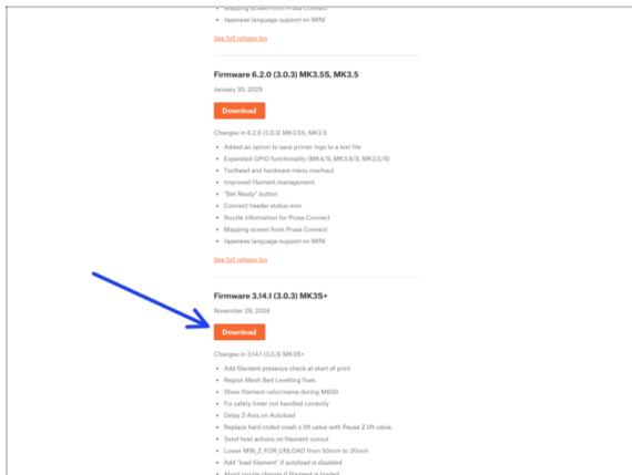
⚠ Deberás actualizar tanto el firmware de la impresora como el de la unidad MMU. Utiliza únicamente una combinación de las versiones de firmware más recientes para ambos dispositivos juntos.
