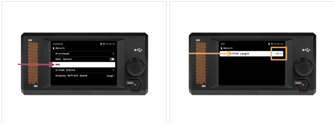
⚠ Die Länge des PTFE-Schlauchs von der MMU zum Extruder muss in der Firmware eingestellt werden.
