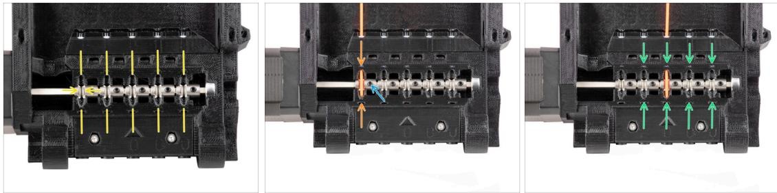
**⚠️ WARNUNG:** Dieser Schritt ist entscheidend, damit die MMU-Einheit richtig funktioniert! **Bitte überprüfen Sie die Ausrichtung der Pulleys mehrmals!!!**
