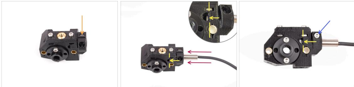
◆ Stecken Sie die M3nS-Mutter in die markierte Öffnung an der Vorderseite des Selektors.
