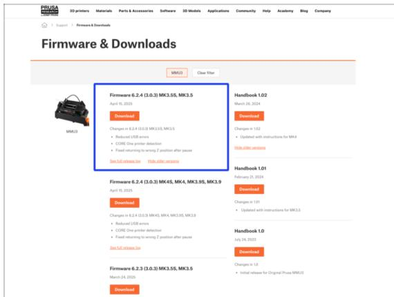
⚠ Sie müssen sowohl die Firmware für den Drucker als auch für die MMU-Einheit aktualisieren. Verwenden Sie nur eine Kombination aus den neuesten Firmware-Versionen für beide Geräte zusammen.
