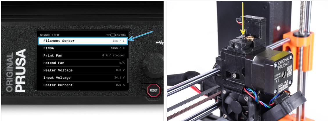
**⚠ Die Kalibrierung des IR-Filament-Sensors ist sehr wichtig, damit die MMU3-Einheit richtig funktioniert!**
