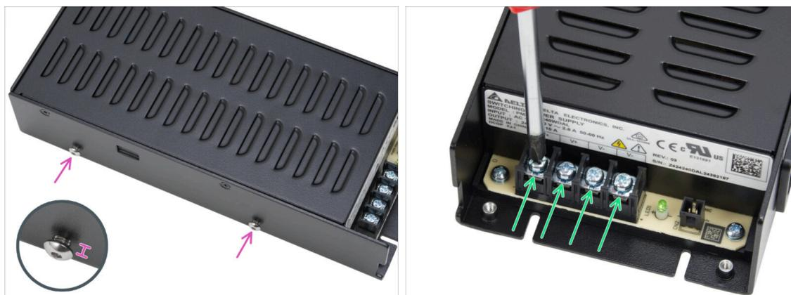
● Inserisci due viti M4x6r sul lato sinistro dell'alimentatore. **Non serrarle completamente.** Lascia almeno 4 mm (0,16 pollici) di spazio tra la testa della vite e l'alimentatore.
