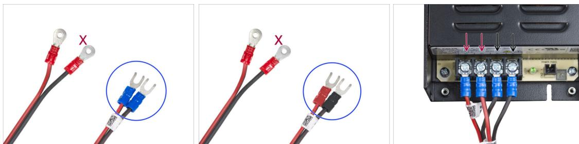
**i** Nei passi successivi, collegheremo i cavi di alimentazione uno per uno. Le viti dei morsetti sono già installate sull'alimentatore. Allentale ma **non rimuoverle completamente** per evitare che si confondano con l'altro tipo di viti utilizzate sul lato della scheda xBuddy. Ciascuno dei due cavi di alimentazione ha due terminali.
