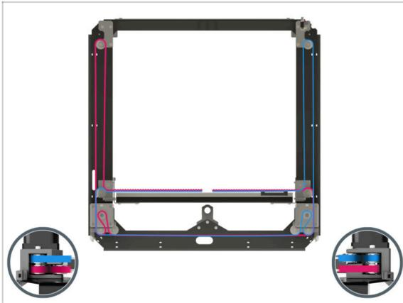
**i** Les étapes suivantes couvrent l'installation et le guidage de la courroie sur l'assemblage du Core XY. Avant de commencer, reportez-vous à l'illustration pour un aperçu et une meilleure compréhension du cheminement de chaque courroie.
