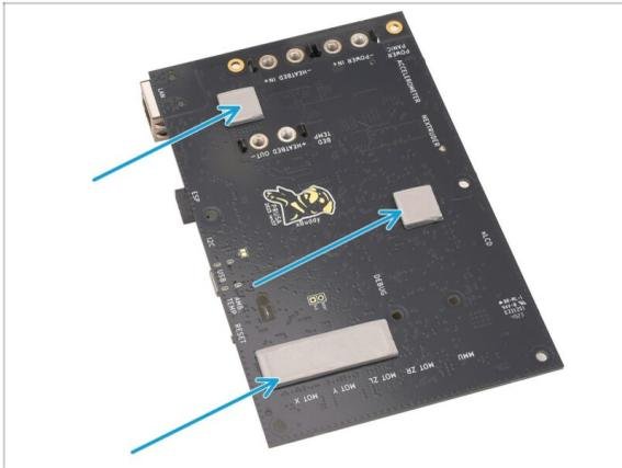
Il se peut que des pads thermiques soient collés à l'arrière de la carte xBuddy. Retirez les pads thermiques et nettoyez tout résidu de colle.
