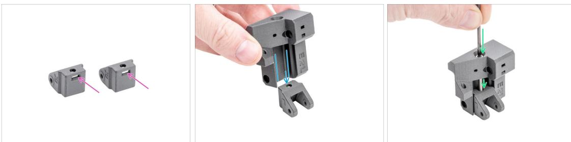
● Insérez un écrou M3nS dans chaque Belt-tensioner-pulley.
