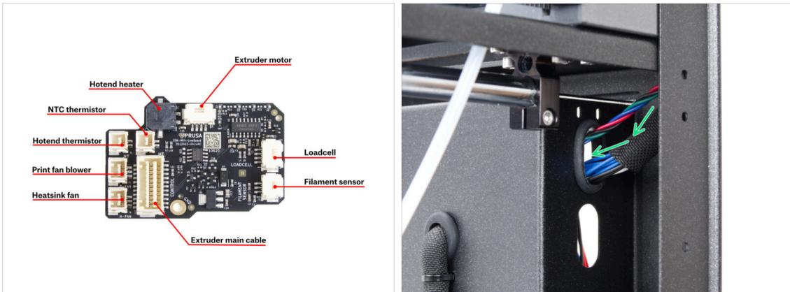
**⚠ Avant de couvrir l'électronique, vérifiez la connexion de tous les câbles.**
