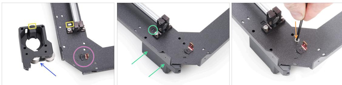
● Localisez le coin de la plaque du CoreXY avec le connecteur Faston dessus. Il se trouve sur la face inférieure de l'assemblage.
