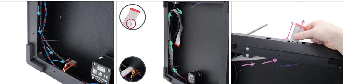
● Guía el Cable splitter motor a través del orificio ovalado hasta la electrónica.
