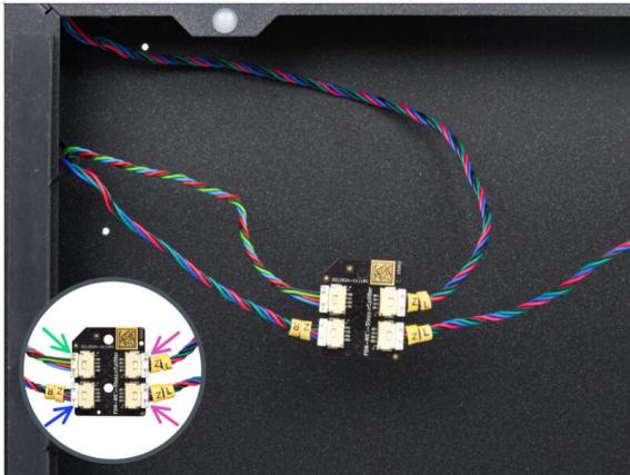
● Conecta los cables del motor Z al stepper splitter:
