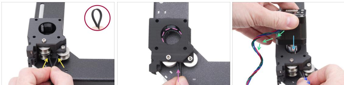
**■** Konzentrieren Sie sich von der Rückseite des CoreXY aus auf die Motorhalterung auf der **linken Seite**.
