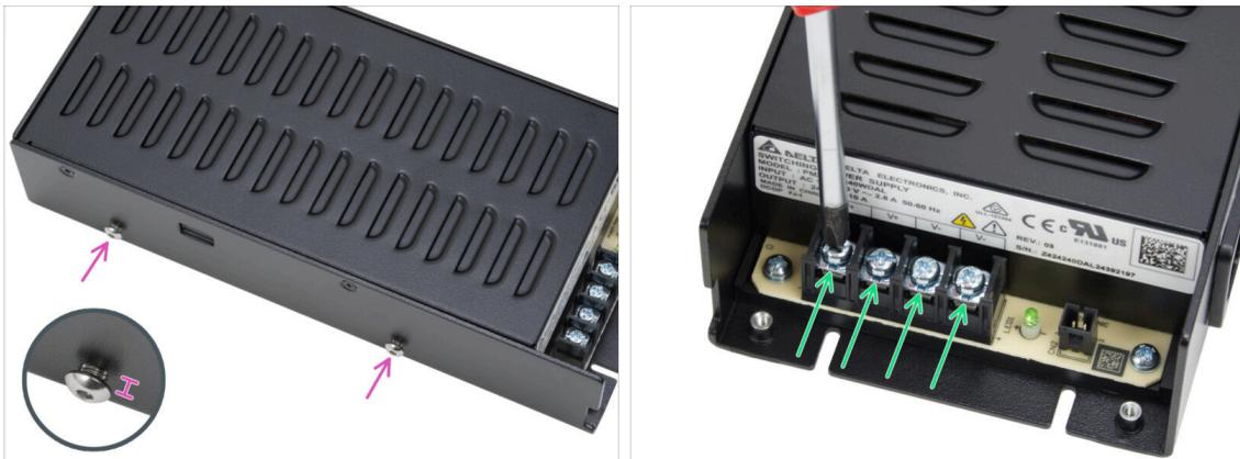
● Setzen Sie zwei M4x6r-Schrauben auf der linken Seite des Netzteils ein. **Ziehen Sie sie nicht vollständig fest.** Lassen Sie mindestens 4 mm (0,16 Zoll) Abstand zwischen dem Schraubenkopf und dem Netzteil.
